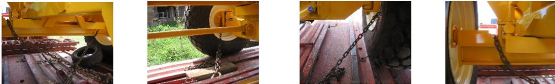
Tener presente la altura del acoplado cargado sobre el camión, sobre todo cuando se transita debajo de puentes, de líneas de cables aéreos y de portones de galpones, para evitar accidentes.
